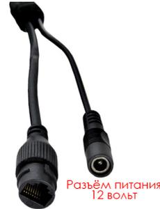
Разъем RJ45 - используется для подключения к сети интернет
